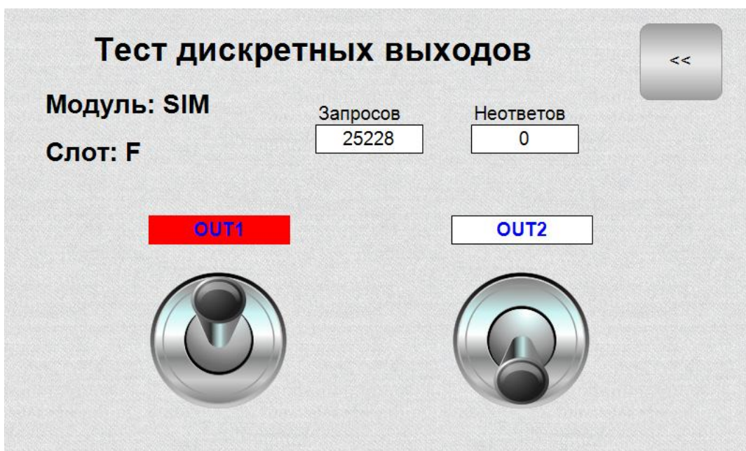
Рисунок 3-6. Экран тестирования модуля дискретных выходов типа «симистор»
