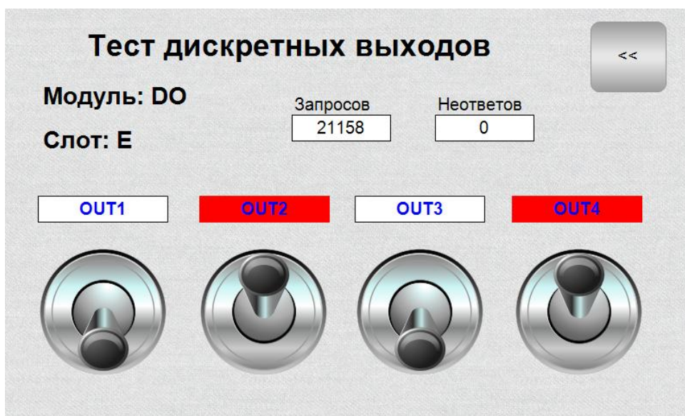
Рисунок 3-4. Экран тестирования модуля дискретных выходов типа «общий коллектор»
