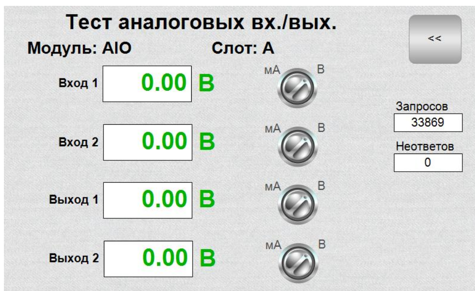
Рисунок 3-3. Экран тестирования модуля аналоговых входов/выходов
