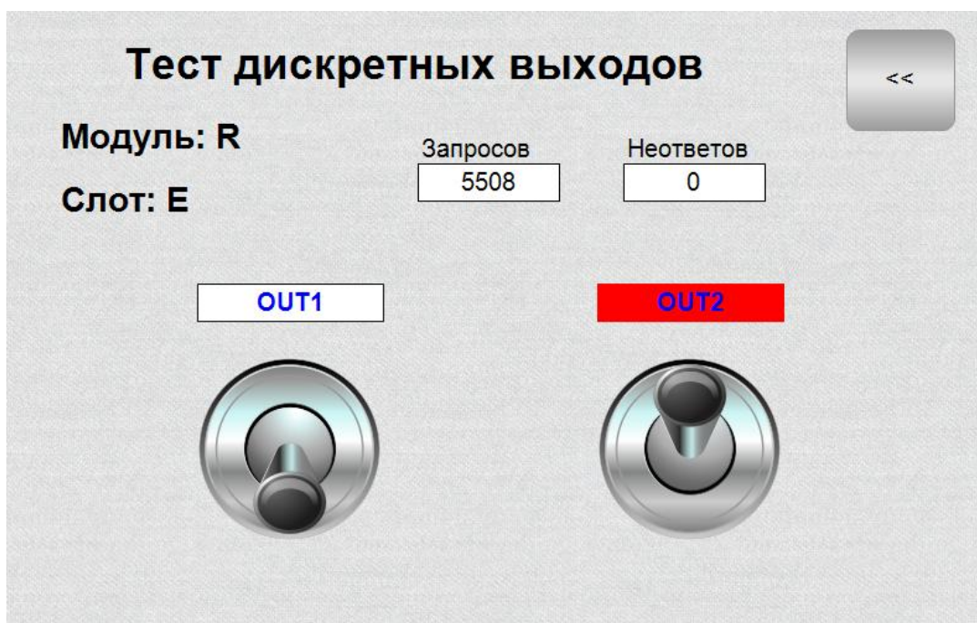
Рисунок 3-8. Экран тестирования модуля дискретных выходов типа «реле»
