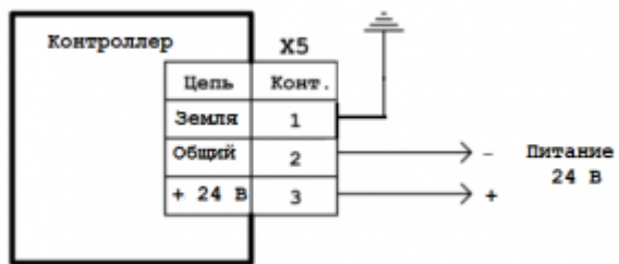
Схема подключения питания АГАВА ПЛК-30.2
