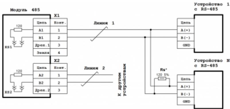
Схема подключения субмодуля 485 к линии RS-485
