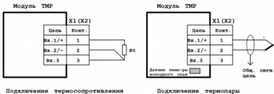
Схема подключения субмодуля измерения температуры TMP
