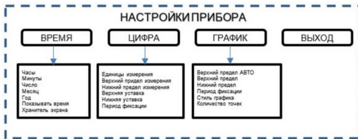
Рис. 2 – Меню настройки прибора
