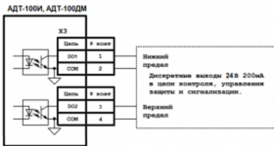
Рисунок А.7 - Схема подключения цепей дискретных выходов
