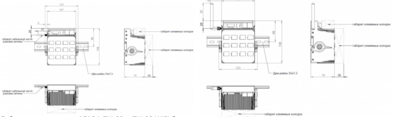
Габаритные размеры АГАВА ПК-60 и ПК-60.WIFI без установленной антенны
