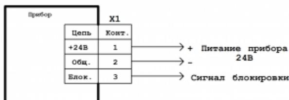
Схема подключения питания и сигнала блокировки к АГАВА ПК-60
