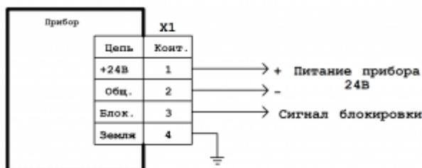
Схема подключения питания и сигнала блокировки к АГАВА ПК-60 ревизия 2
