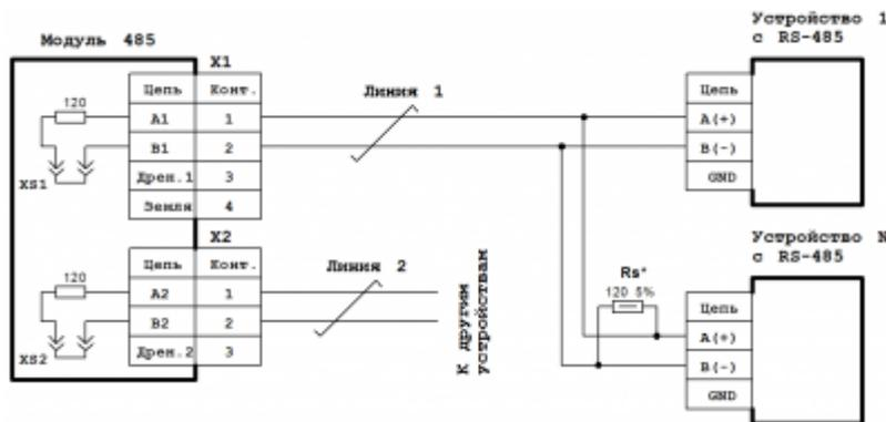
Схема подключения субмодуля 485 к линии RS-485
