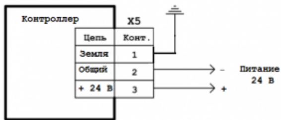
Схема подключения питания АГАВА ПЛК-30.2
