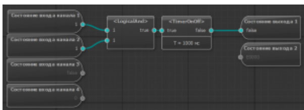
Рисунок 18 – Вид блоков задачи в режиме онлайн отладки
